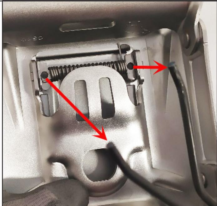
Après l'assemblage, pivotez légèrement l'outil pour permettre aux goujons d'entrer dans les logements rectangulaires de la poignée et retirez délicatement l'outil.
